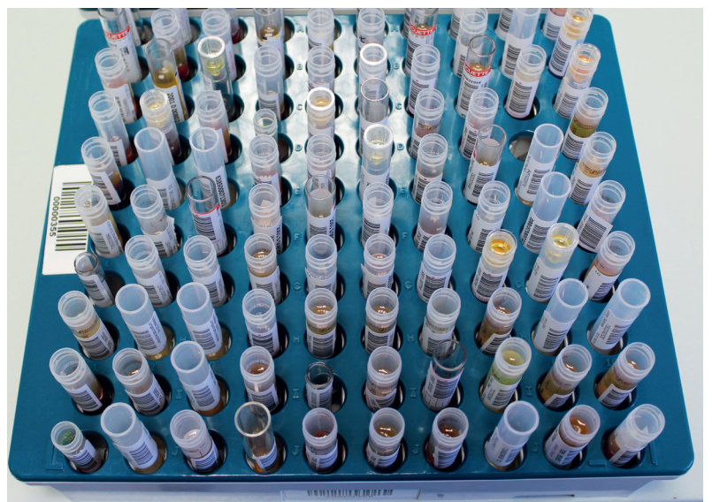
Die überwiegende Mehrheit der Proben steht auf einem Rack bereit für die Routine-Analyse und wird über einen Loader automatisiert abgearbeitet
